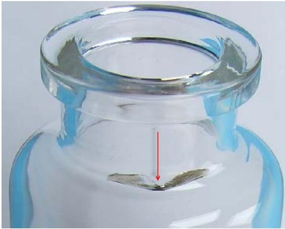
**Figura 2:** Colo e início da parte mais larga do frasco para injectáveis com fissura.
