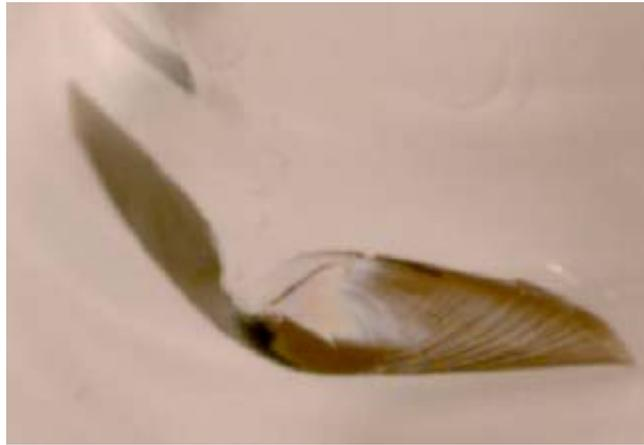
**Figura 3:** Fissura com forma semelhante a uma borboleta.
